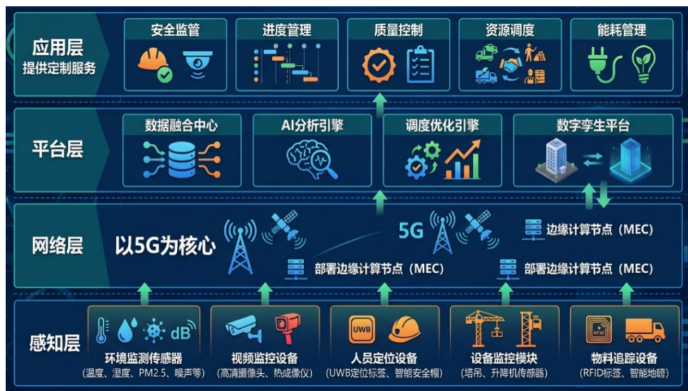
图 1 “感知层—网络层—平台层—应用层”四层体系结构
